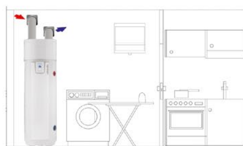
Instalacja w pomieszczeniu nieogrzewanym (kubatura >20 m 3 )
