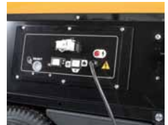
Panel sterujący z gniazdem termostatu (mechanicznego lub elektronicznego)
